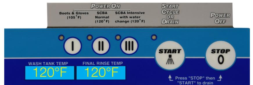
**REMARQUE:** Lors du nettoyage d'un ARI/ EPI très sale, choisissez le **cycle III (3)**. Ce cycle nettoie l'équipement, puis rince automatiquement l'intérieur de la machine, et vidange et remplit le réservoir pour qu'il soit prêt pour le prochain lavage.
