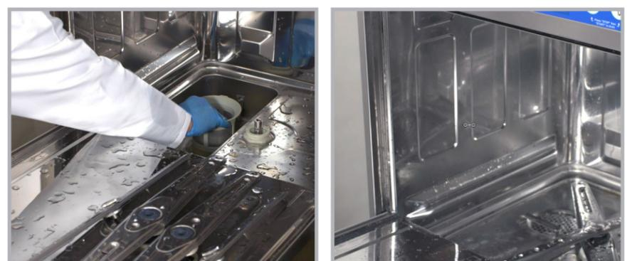
Remplacez toutes les pièces nettoyées. Laissez la porte ouverte jusqu'à la machine soit sèche.
